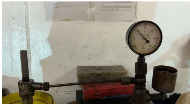
Gambar 2. Pressure test injector sebelum maintenance Sumber: Dokumentasi Peneliti
