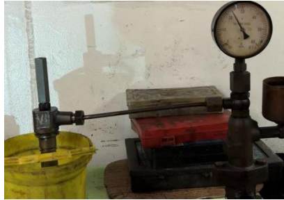
Gambar 8. Pressure test injector setelah maintenance
