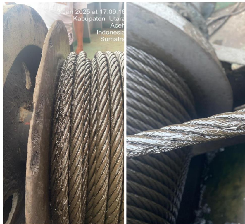
Gambar 3. Kegiatan Inspeksi Wire Rope Ketika Proses Bongkar Muat Mv. Hodasco 19, Sumber : Dokumen Peneliti (2025).
