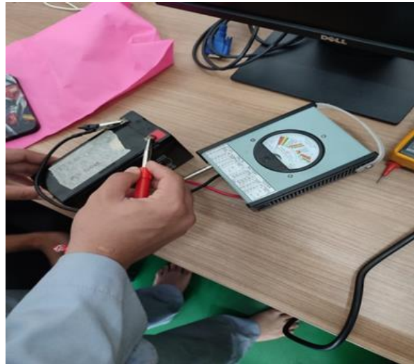
Gambar 5. Pengukuran batterai dengan alat Ampermeter
