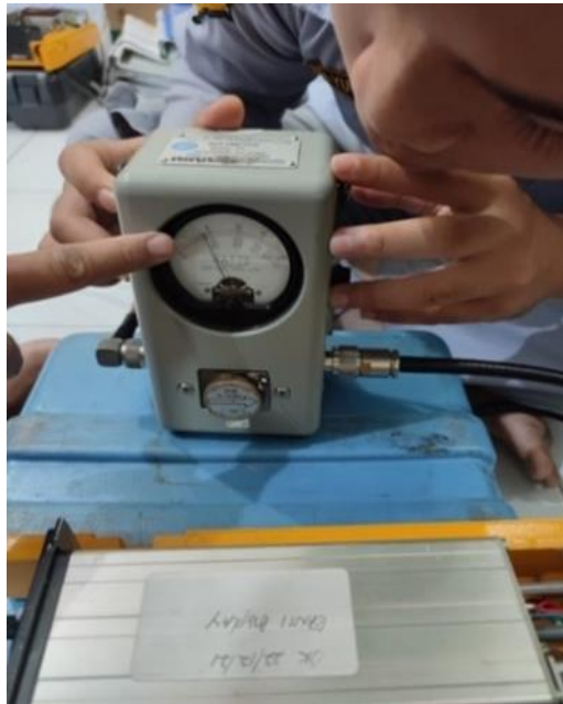
Gambar 7. Hasil Pengukuran dengan alat ukur Wattmeter setelah pergantian spare baru
