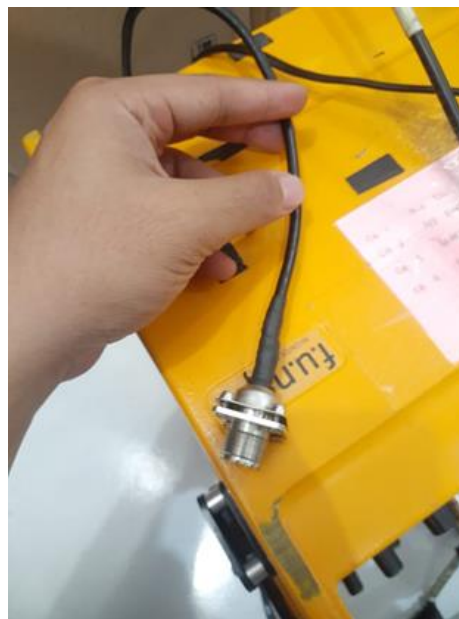
Gambar 4. Penggantian kabel konektor baru Sumber: Kantor LPPNPI Cabang Palembang
