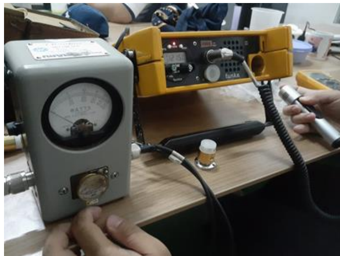
Gambar 2. Pengukuran power pancar dengan alat ukur wattmeter
